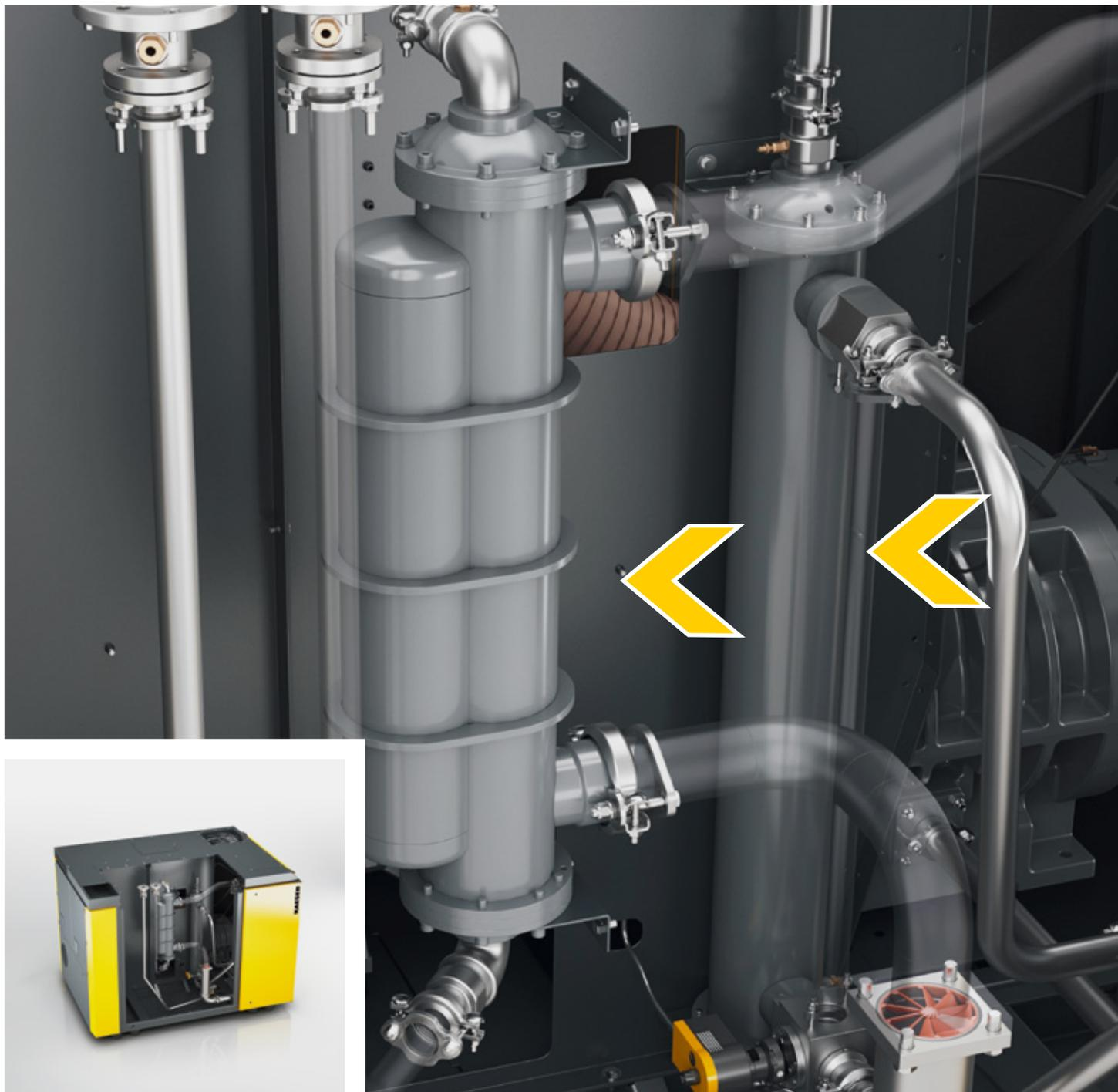
Por fornecer um desempenho de resfriamento suficiente, os trocadores de calor casco e tubo, feitos de liga de cobre-níquel (CuNi10Fe), são menos propensos a contaminação, são mais robustos e podem ser limpos mecanicamente. Além disso, as inserções mais frias podem
