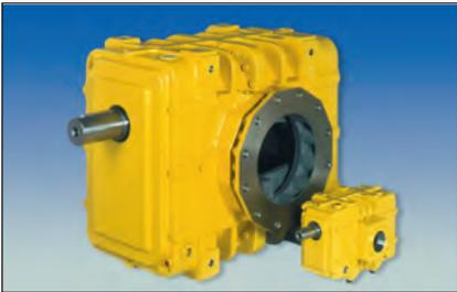
Com modelos de dois ou três lóbulos, os sopradores Omega e Omega Plus, com deslocamento positivo, possuem vazão de 155 m<sup>3</sup>/min (5500 pcm), pressão de 1.03 bar (15 psig) e vácuo de 685 mmHg. A construção pesada proporciona longa durabilidade e operação silenciosa.
