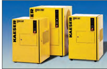
Os compressores de pistão Airbox isentos de óleo, variam em tamanho entre 3 e 11 kW (4 e 15 hp), fase única, com pressão até 8.6 bar (125 psig). O gabinete de metal a prova de ruídos garante um nível sonoro muito baixo, o que torna
